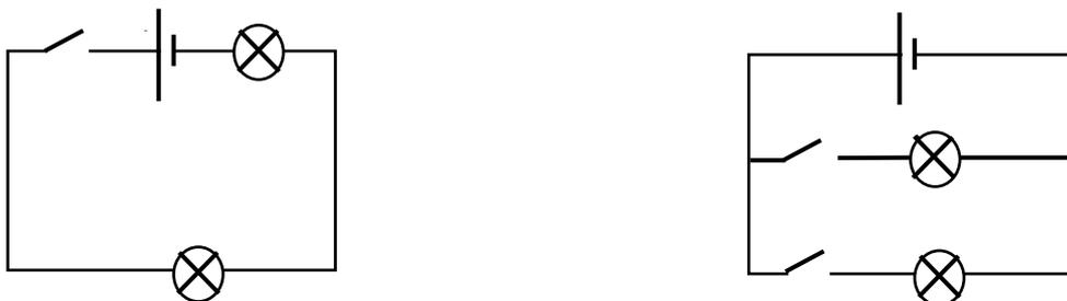
Dans le cas du circuit de gauche (circuit en série), il n'est pas possible de commander les deux lampes de façon indépendante. Dans le circuit de droite (circuit en dérivation), les deux lampes sont commandées de façon indépendante.
